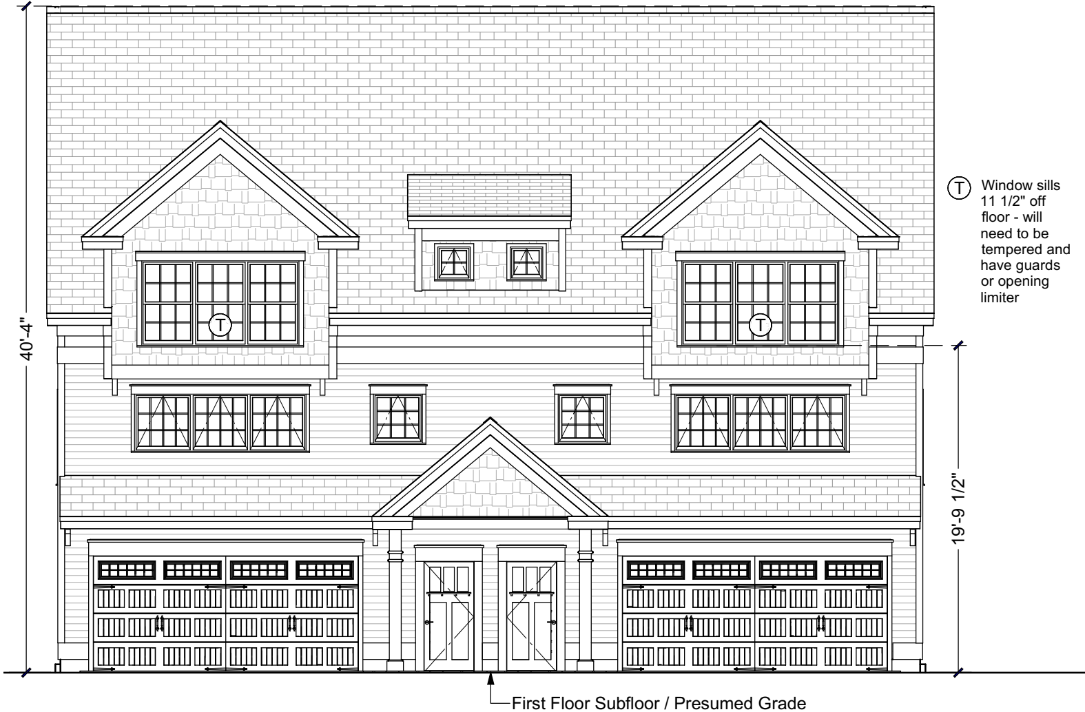
Front Elevation Scale: 1/8" = 1'-0"
